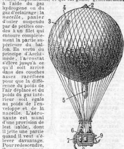
Ballon sphérique : 1. Enveloppe; 2. Soupape; 3. Filet; 4. Volet ou panneau de déchirure pour dégonfler le ballon; 5. Appendice ou manchon, ou manche; 6. Nacelle; 7. Guiderope; 8. Sacs de lest; 9. Ancre.
