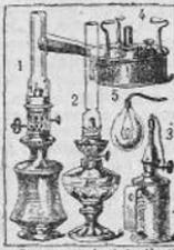
Lampes : 1. A huile à modérateur ; 2. A pétrole, etc. ; 3. A alcool ; 4. A et qui sert de réchaud ; lampe à alcool ; 5. Electrique à alcool ; lampe à souder. (à incandescence).
