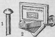
Repères de nivellement : 1. Repère secondaire ; 2. Repère principal.
