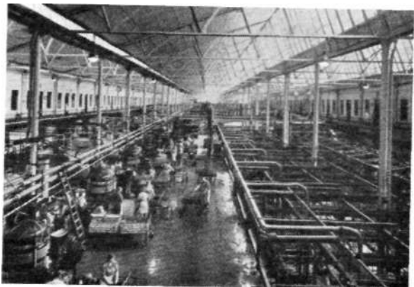
Ølftapningshal på Carlsberg Bryggerierne. En af verdens største. 2 3 / 4 mill. flasker i døgnet.
